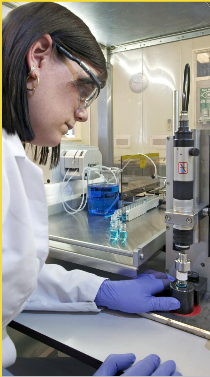
Remplissage et capsulage stériles de flacons dans des environnements aseptiques
