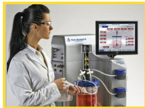
Pompes OEM intégrées à un bio réacteur à usage unique
