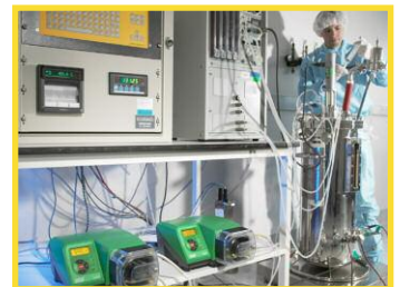
Deux des cinquante pompes utilisées avec des cuves de fermentation pour la production de kits d'analyse
