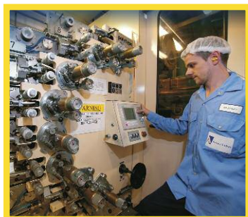
Dans un environnement de manipulation de laques, les pompes à commande directe font gagner du temps et de l'argent
